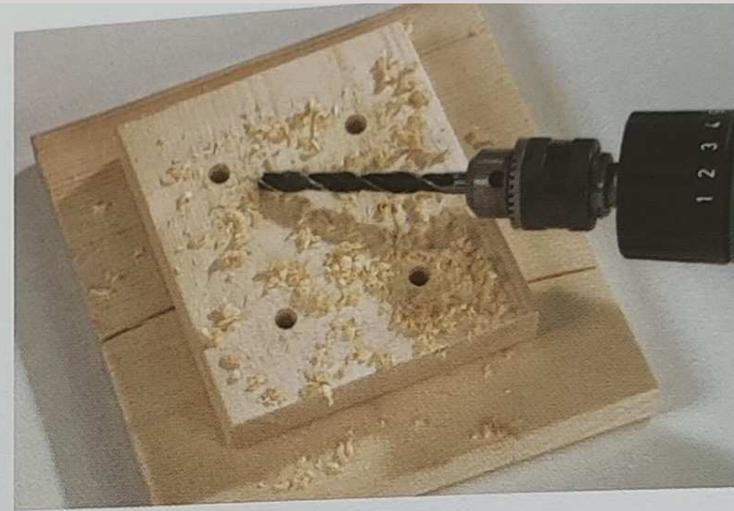
Der Nistkastenboden (B) erhält 4–5 Bohrungen, damit Feuchtigkeit abziehen kann.
